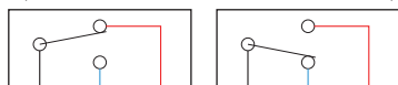
黒 (COM) 青 (NO) 赤 (NC) コネクタ未挿入時 黒 (COM) 青 (NO) 赤 (NC) コネクタ挿入時 When connector uninserted When connector inserted
