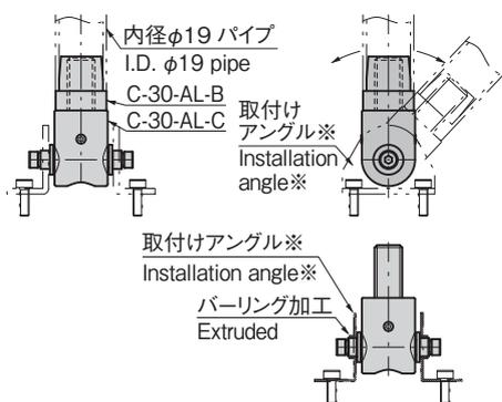
※取付けアングルが2.5mm以下の薄板の場合、軸穴部にパーリング加工をおすすめします。
