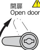
⚠ 振動や止め金の自重落下防止のため開扉の際止め金が上方に回転する設定をお奨めします。
