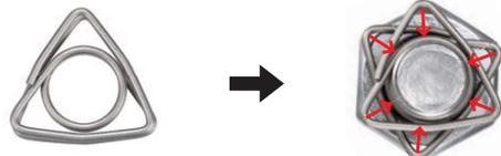
ボルトに脱落防止スプリングを装着すると、外形が三角形から六角形に変位。ねじ部に緊張力が発生し、ナットの脱落を防止します。
